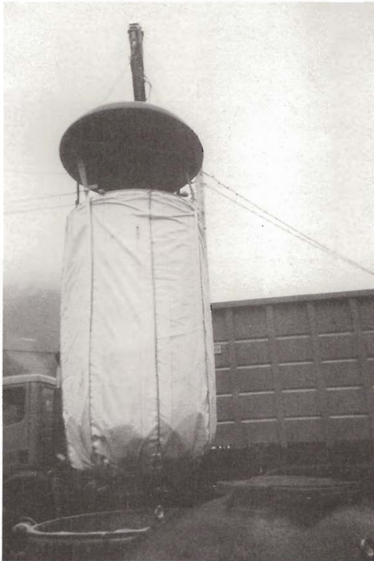
Collecte de conteneurs enterrés
